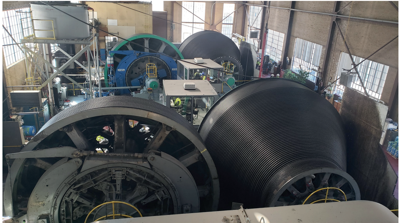
图4：罗斯井的机房和两台缠绕式提升机视图——前侧是生产提升机的两个滚筒；后侧是提人提升机的滚筒；在它们之间，有两个位于操作室内的控制站。
