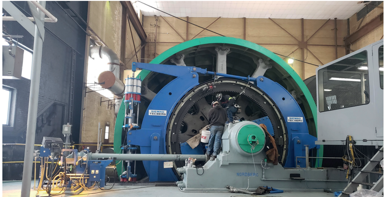
图5：带新联轴器和新制动系统的提人提升机视图
