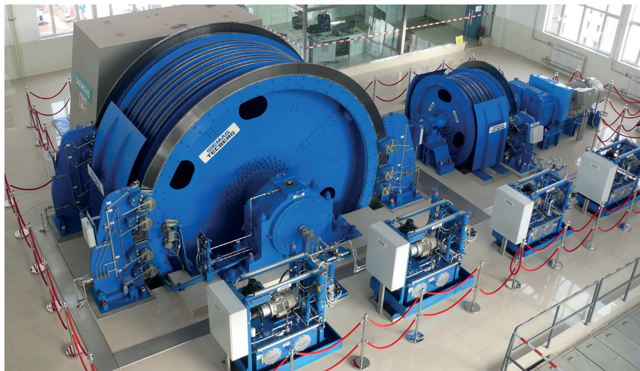
Рис. 2: Реализованный проект SIEMAG TECBERG - шестиканатная машина системы Кёпе башенного исполнения. Copyright 2022 Tianjin SIEMAG TECBERG.
