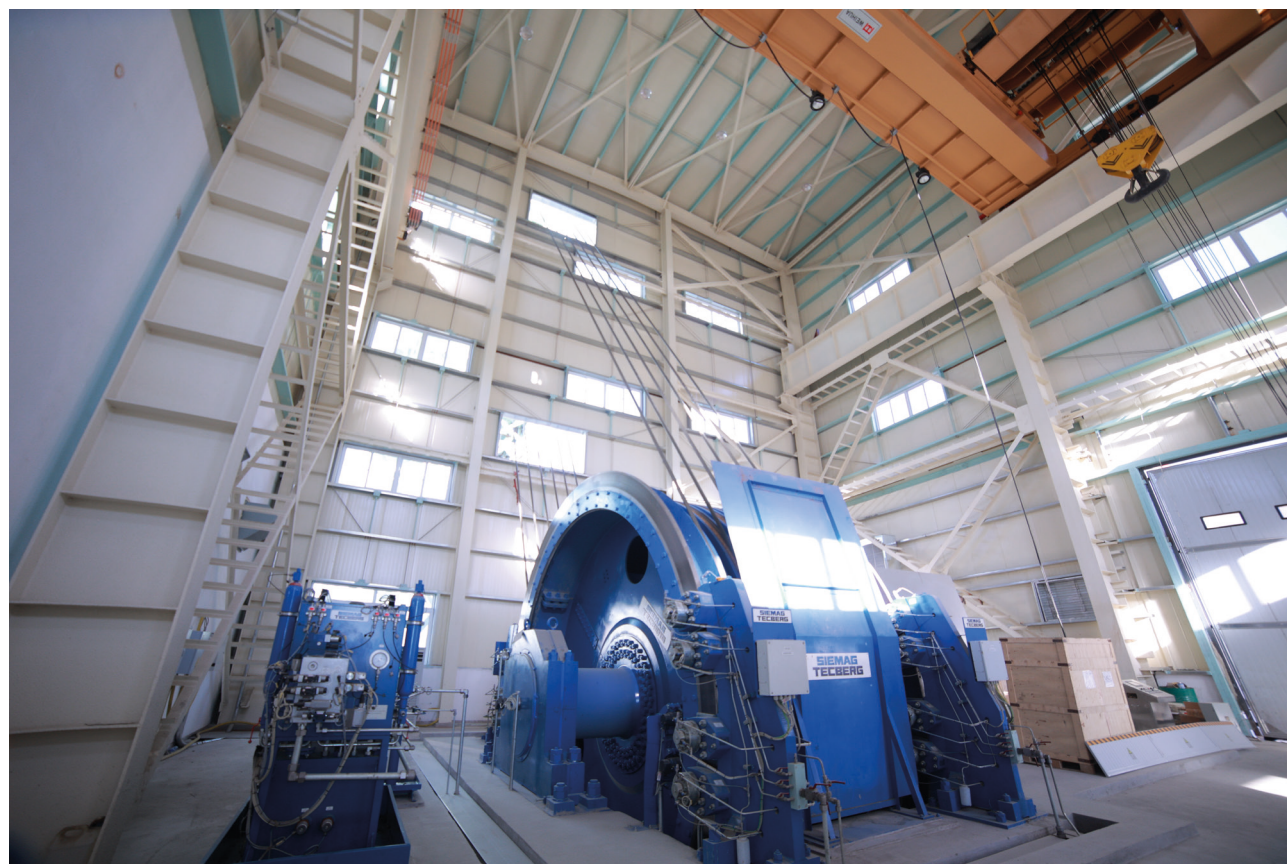
Рис. 1: шестиканатная подъемная машина системы Кёпе вспомогательного ствола уже в эксплуатации.
