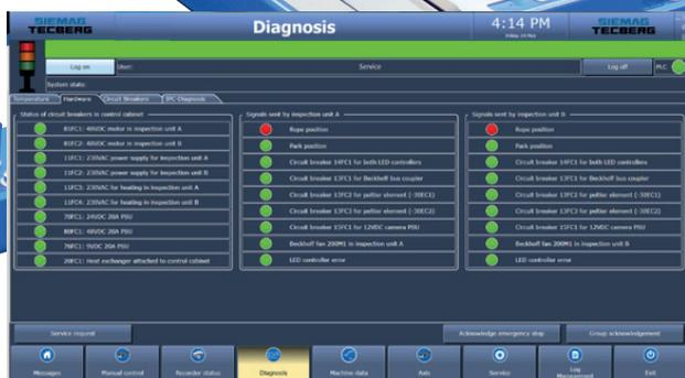
Диагностика аппаратного обеспечения: отображает общую информацию о состоянии системы. Дополнительно здесь возможно отслеживание сигналов, полученных от системы управления устройством.
