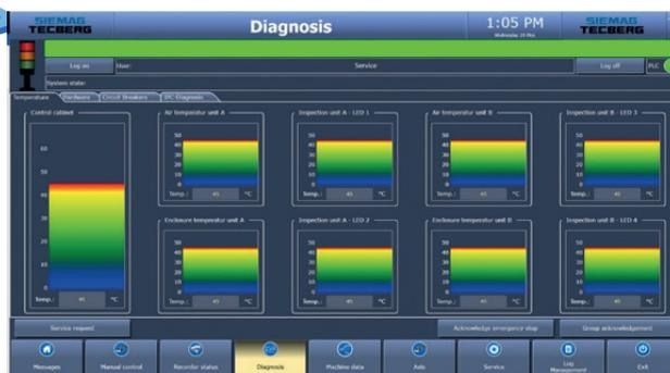
Диагностика температуры: мониторинг температуры внутри шкафа управления и модуля контроля.
