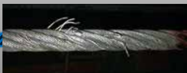
Drahtbruch mit abstehenden Drahtstücken
